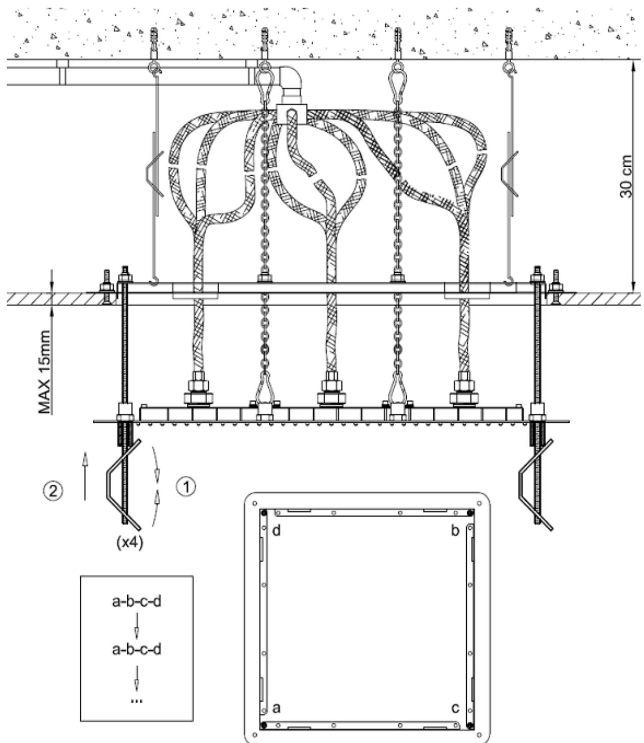
Visser la tige filetée avec système à ressort dans les 4 points indiqués ci-dessus, puis effectuer la séquence décrite (a-b-c-d) afin de plaquer le plafond de douche sur le faux plafond.
