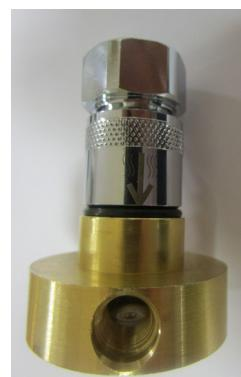
**Le plafond référence 487 est équipé d'un clapet de sécurité.**
