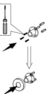
5. Установите держатель (поз. 9) с помощью крепежного комплекта. Закройте крепление декоративной накладкой.
