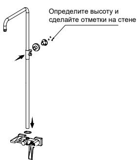
4. Прикрепите душевую стойку (поз. 1) к смесителю (поз. 3). Определите необходимую высоту крепления держателя душевой стойки (поз. 9) и сделайте отметку.
