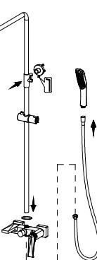
6. Прикрепите душевую стойку (поз. 1) к смесителю (поз. 3). Установите держатель душевой стойки (поз. 9). Подключите душевой шланг (поз. 8), лейку (поз. 7) и верхний душ (поз. 2).
