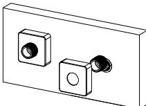
2. Прикрутите настенные отражатели (поз. 4) к эксцентрикам (поз. 4).
