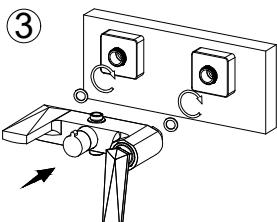
3. Установите резиновые уплотнители на гайки смесителя (поз. 3) и закрепите смеситель на эксцентриках (поз. 4) с помощью гаечного ключа.
