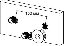
1. Обмотайте лентой резьбовые соединения эксцентриков (поз. 4) и вкрутите их в водопроводные выходы на стене. После этого промойте водопроводные трубы в течение 30–60 секунд, чтобы удалить возможные загрязнения.
