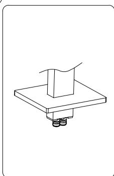
3. Закрепите отражатель на основании смесителя.
