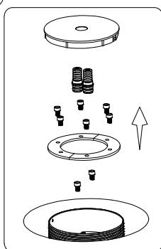
2. Снимите защитный кожух с монтажного блока.
