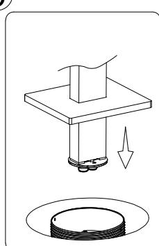
5. Установите трубку смесителя на монтажный блок, выровняйте направление. При необходимости поверните излив на 360° перед окончательной фиксацией.
