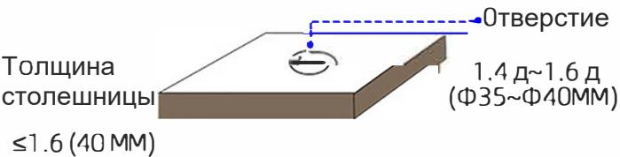
② Необходимые для работы инструменты : Разводной ключ, отвёртка и перчатки(не поставляются в комплекте). Вставьте смеситель и шланги в столешницу. Используйте перчатки на протяжении всех монтажных работ.
