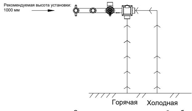
Схема установки водопроводной трубы
