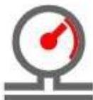
Рабочее давление воды (горячей и холодной) — 3-5 бар.
